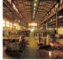
1900年、製鐵所で使用する機械の修繕、部材の製作加工等のため、ドイツのGHH社設計で鋼材を用いて建設された。その後鋼材生産量増大に伴い3回増築。創業以来110年以上現役で稼動中。
