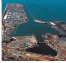
遠浅で干満差の激しい有明海上に大型船を接岸し効率よく三池炭を輸出する積出港としてハミングバードの形状に設計。砂泥対策の防砂堤、潮待ちの内港、潮位差調整の閘門等の港湾施設が築港時の物流インフラを証言。現役の産業港。
